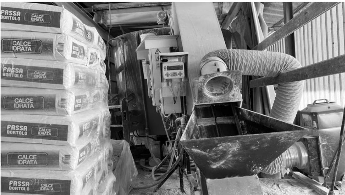
Die mobile Mischanlage ist eine Eigenentwicklung und soll künftig dort zum Einsatz kommen, wo Hanfbetonwände gebraucht werden.
